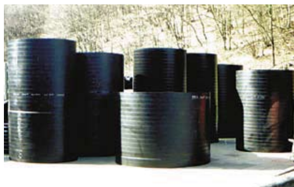
Вертикальні «секційні» резервуари для індустріального використання
